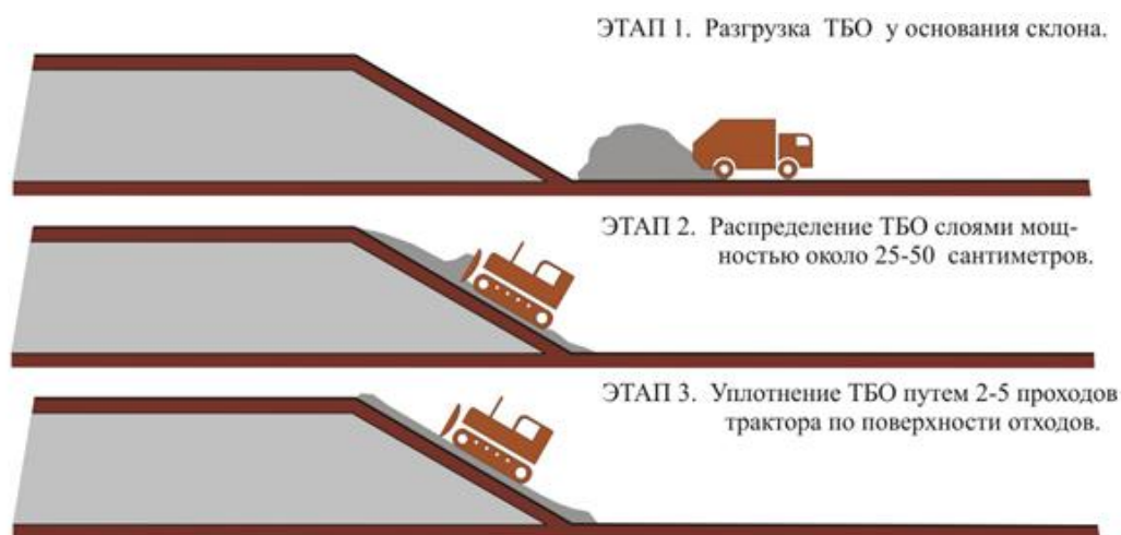
Рисунок 4 - Процесс загрузки и уплотнения отходов методом "надвига".
