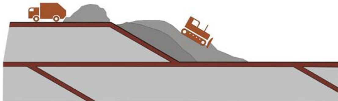
Рисунок 5 - Процесс загрузки и уплотнения отходов методом "сталкивания".
